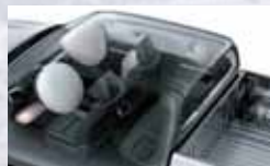
Airbags frontales (conductor y acompañante), de rodilla (conductor), laterales (x2) y de cortina (x2).
