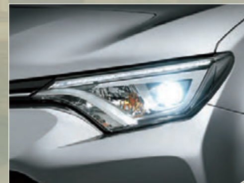
Faros delanteros Bi-LED con regulación automática en altura y luces diurnas (DRL). 1
