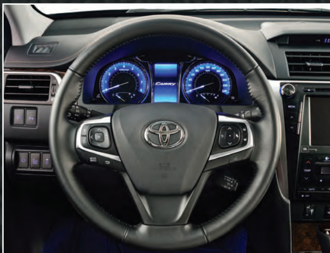
Volante de 3 rayos forrado en cuero natural con comando satelital del audio y display de información múltiple (TFT) 2
