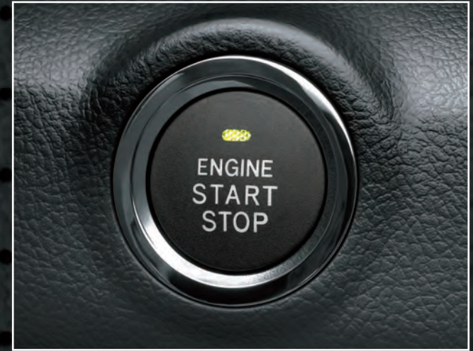
Push Start Button (botón de arranque) y smart entry system (apertura sin llave)
