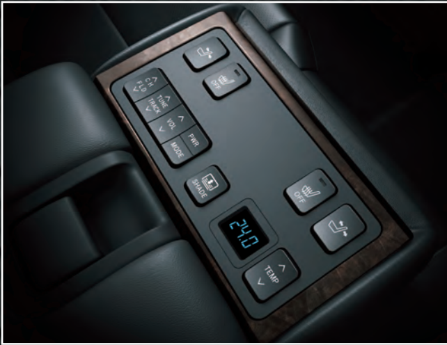
Apoyabrazos trasero central con comando de climatización, calefacción de asiento, audio y cortina parasol trasera. 1
